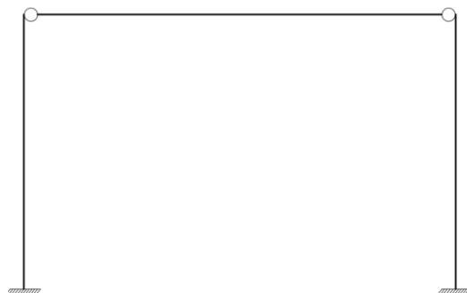
1.7 pav. Statiškai neišsprendžiamos sistemos pavyzdys su lanksčiais ir standžiais mazgais
