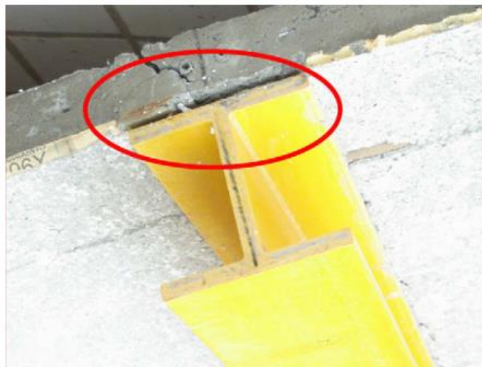
3.12 pav. Perdangos bandinys Nr. 1: jungties tarp betono ir GFRP profiliuotio suirimo atvejis (Santos Neto & La Rovere 2010: 2561)
