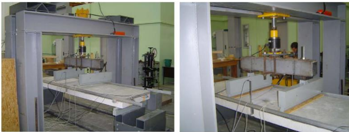
3.10 pav. 4 taškų lenkimo bandymo įrenginys (Santos Neto & La Rovere 2010: 2560)
