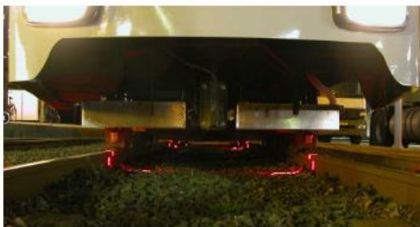
1 pav. „Mermec“ inercinė (viršutinė nuotrauka) ir optinė (apatinė nuotrauka) NGMS (Marmec, 2019)
