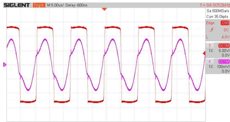
44 pav. Srovės (violetinis) ir įtampos (raudonas) signalai imtuve, kai turima netiesinė apkrova
