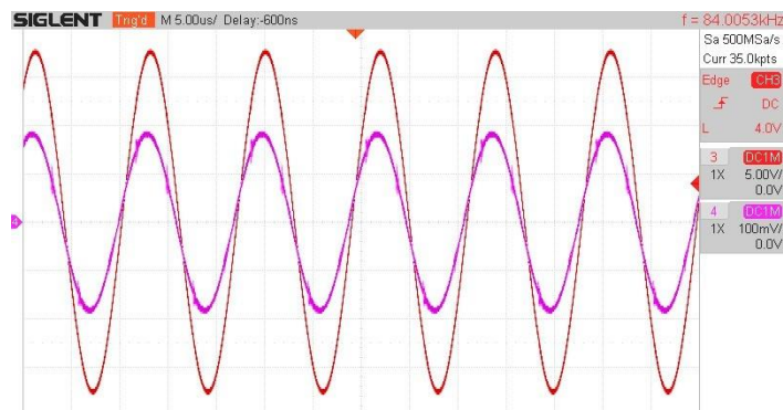
43 pav. Srovės (violetinis) ir įtampos (raudonas) signalai imtuve, kai turima tiesinė apkrova
