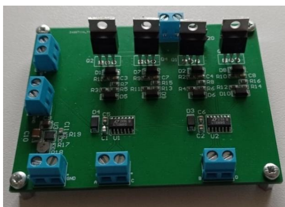
36 pav. Pagaminta ir surinkta bevielio energijos perdavimo siūstuvo sistema
