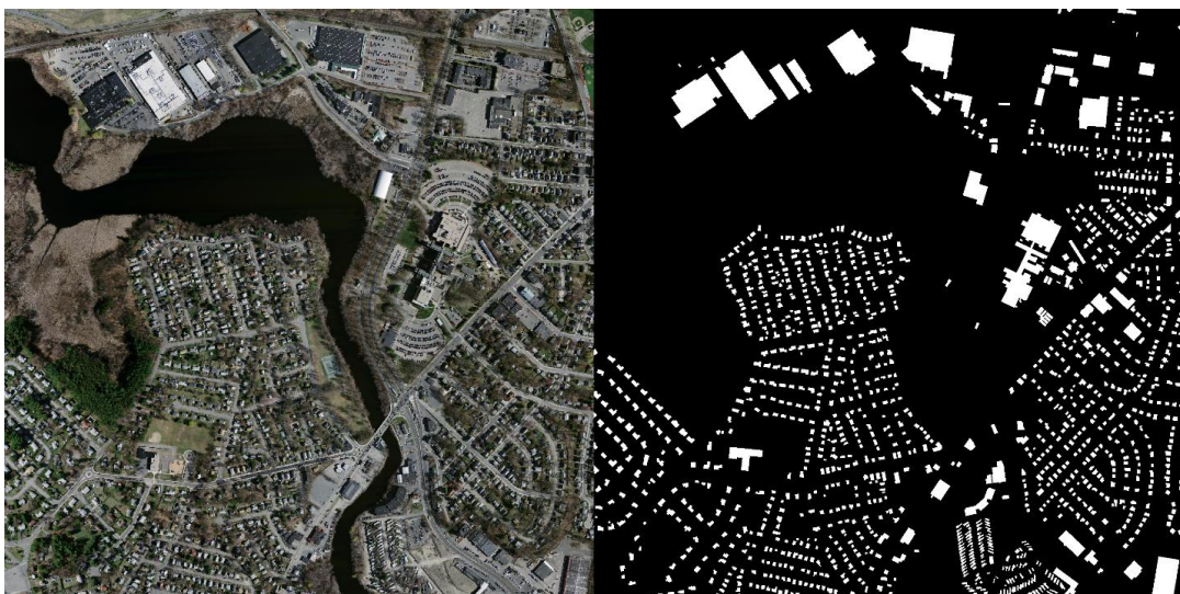
3.3.1 pav. Masačusetso pastatų duomenų rinkinio aerofotografinė nuotrauka ir kaukė [68]
