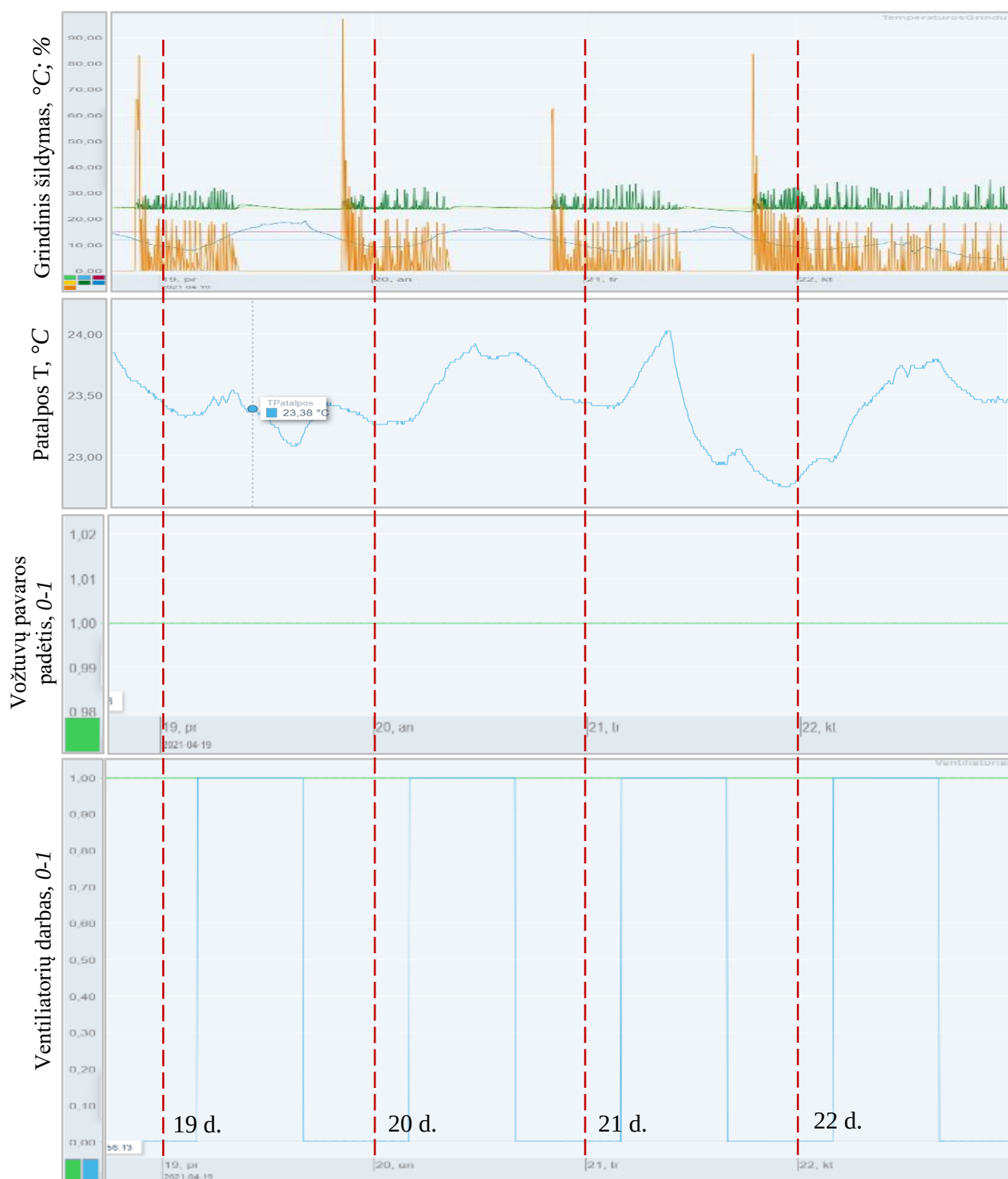
24 pav. Konvektorių darbas 2 aukšte
