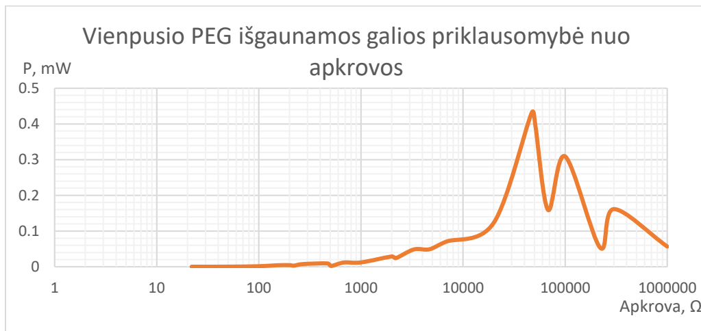
3.5 pav. Vienpusio PEG išgaunamos galios priklausomybė nuo apkrovos
