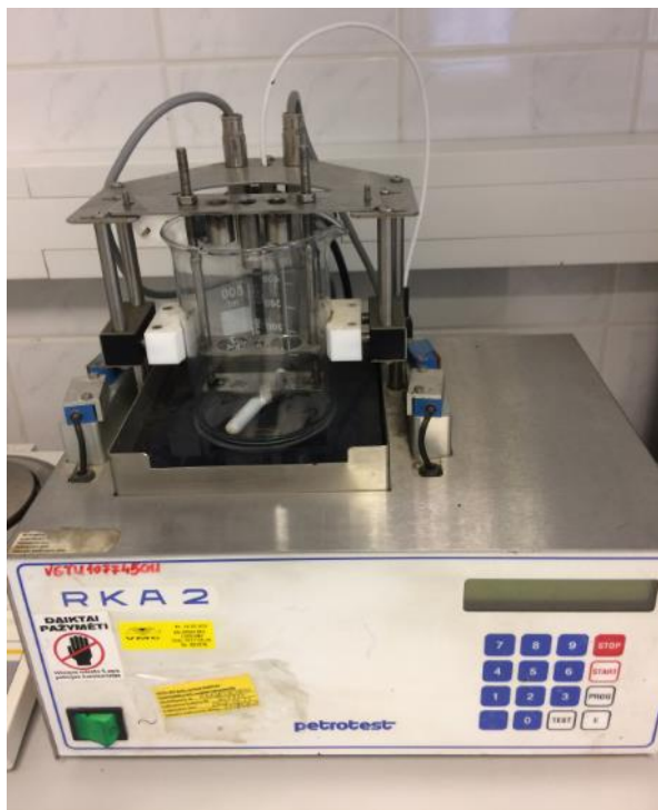
12 pav. Minkštėjimo temperatūros nustatymo prietaisas
