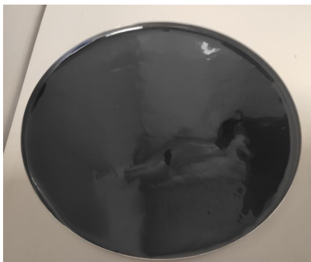
16 pav. Bitumas lėkštelėje ilgalaikiui sendinimui
