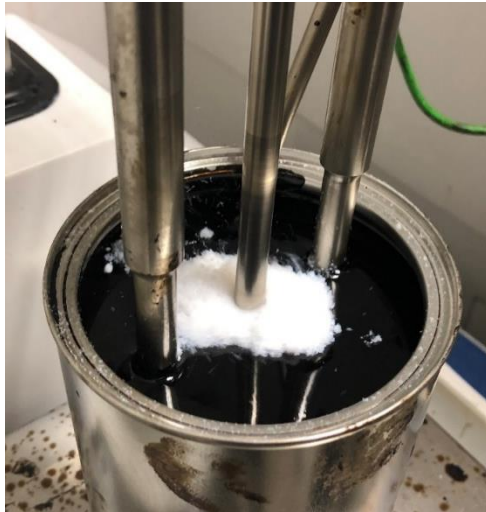
21 pav. Bitumo modifikavimas pridėtiniu parafininio vašku a) pridėtinis parafininis vaškas suberiamas į iškaitintą bitumą b) kaitinamo bitumo ir pridėtinio parafininio vaško maišymas didelio maišymo greičio maišytuvu
