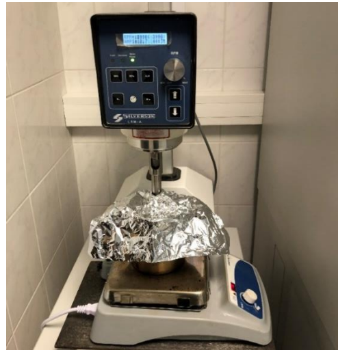
21 pav. Bitumo modifikavimas pridėtiniu parafininio vašku a) pridėtinis parafininis vaškas suberiamas į iškaitintą bitumą b) kaitinamo bitumo ir pridėtinio parafininio vaško maišymas didelio maišymo greičio maišytuvu
