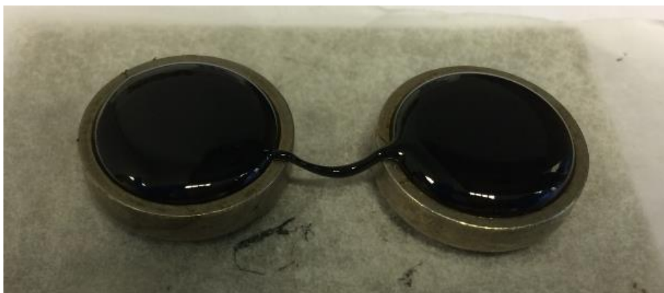
13 pav. Žalvariniai žiedai ant metalinės plokštelės pripildyti bitumu
