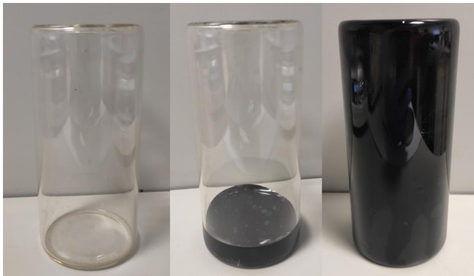
15 pav. Bitumas supilamas į stiklinius indus trumpalaikiui sendinimui
