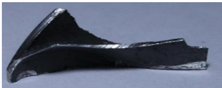
11 pav. Pažeista turbokompresoriaus mentė Šaltinis: Channiwal, 2017
