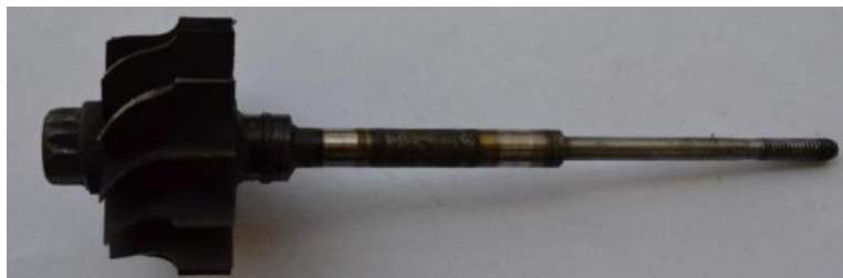
12 pav. Pažeistas rotoriaus velenas
