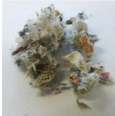
1 pav. Gamtinė termoizoliacinė medžiaga, pagaminta iš perdirbto popieriaus
