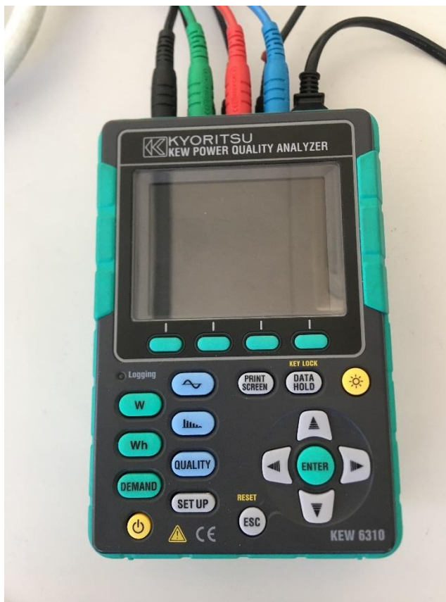
2.23 pav. Galios kokybės analizatorius.
