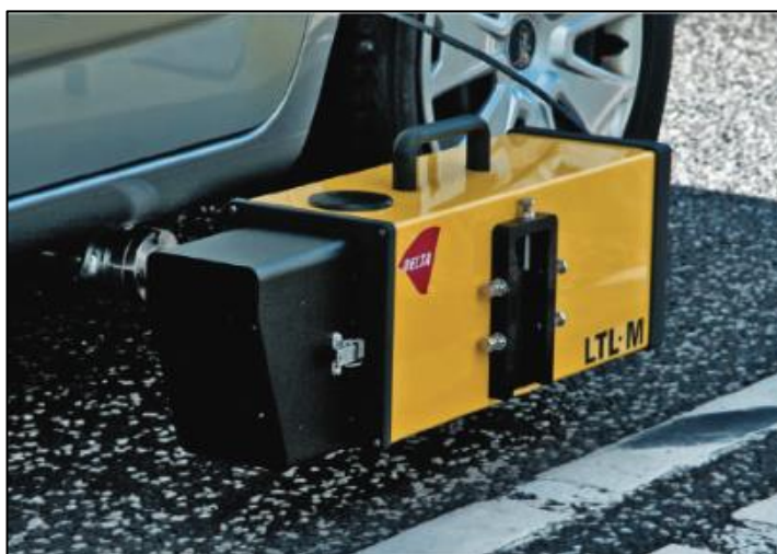
2.3 pav. Dinaminis retroreflektometras DELTA LTL-M ( tecnos.ro )
