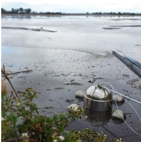
1.9 pav. Gaubtas oro mėginiui nuo vandens paviršiaus paimti (AC'SCENT flux... 2020)
