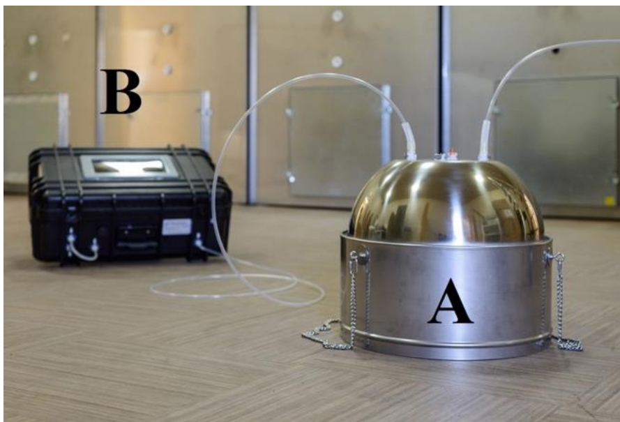
1.11 pav. AC'SCENT gaubtas (A) ir vakuuminė kvapo mėginių ėmimo kamera (B) (AC'SCENT products... 2016)
