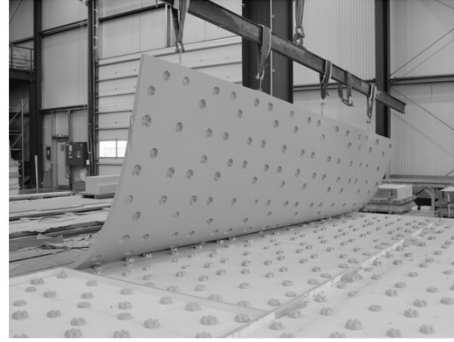
1.27 pav. Lanksčios klojinių matricos pavyzdys iš Reckli gamyklos Vokietijoje Fig. 1.27. Example of a formliners from the Reckli plant in Germany
