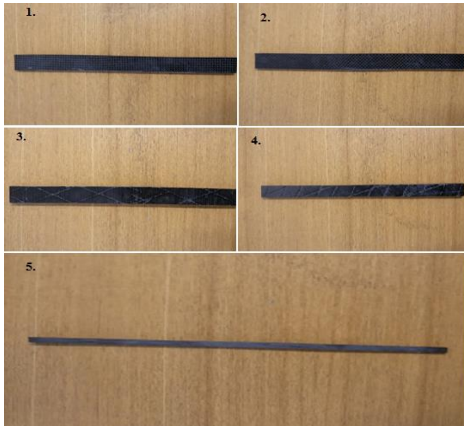
2.1 pav. Bandiniai tempimo bandymui: 1. Anglies audinys orientuotas 90° kampu; 2. Anglies audinys orientuotas 45° kampu; 3. Anglies pluoštas Zoltek orientuotas 90° kampu; 4. Anglies pluoštas Zoltek orientuotas 45° kampu; 5. Anglies pluoštas Zoltek orientuotas 0° kampu.
