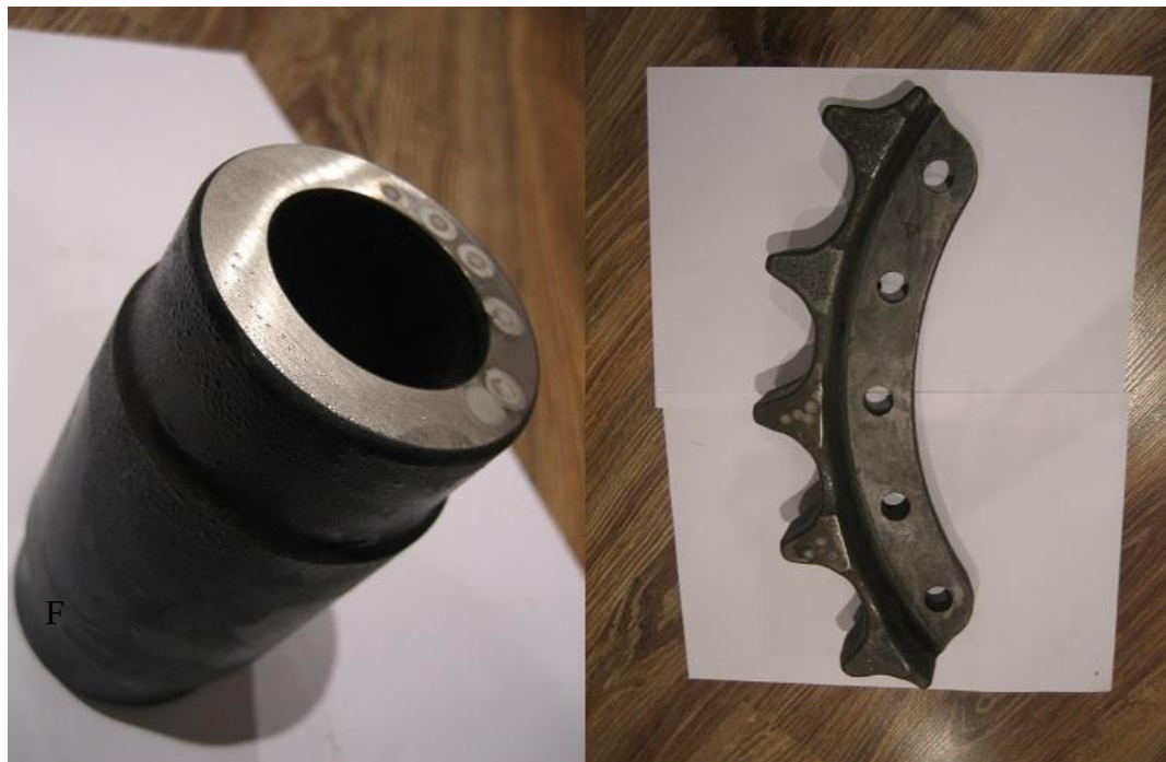
3.11 pav. Varančiosios grandinės įvorė ir neoriginalus segmentas po metalo cheminės sudėties nustatymo
