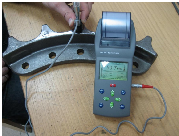
3.7 pav. Neoriginaliojo varančiosios žvaigždutės segmento kietumo matavimas Šoro metodu
