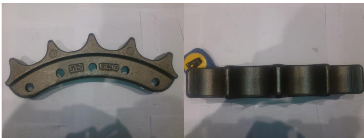
3.3 pav. Neoriginalus, Pietų Korėjoje pagamintas, varančiosios žvaigždutės segmentas
