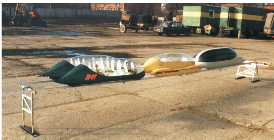
1.16 pav. Styginio transporto bandomieji modeliai (Unitsky 2008)
