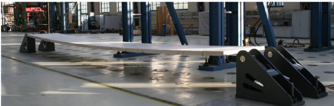
1.4 pav. Anglies pluošto vienajuosčio tilto modelis (Bleicer, Schlaich et al. 2011)
