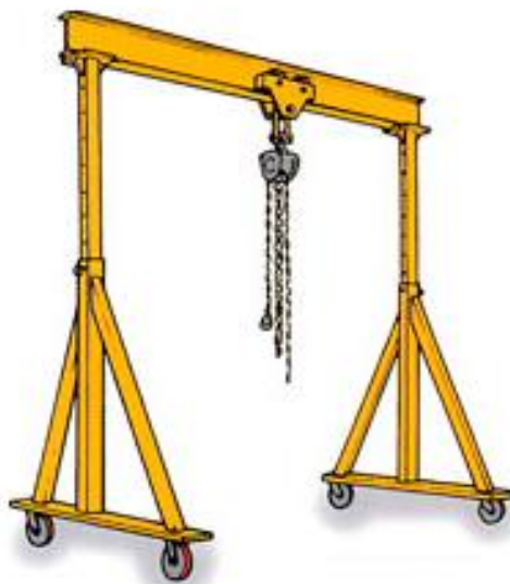
2.2 pav. Reguliuojamo aukščio konstrukcija.
