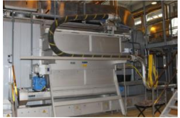
9 pav. Dumblo džiovinimo įrenginys
