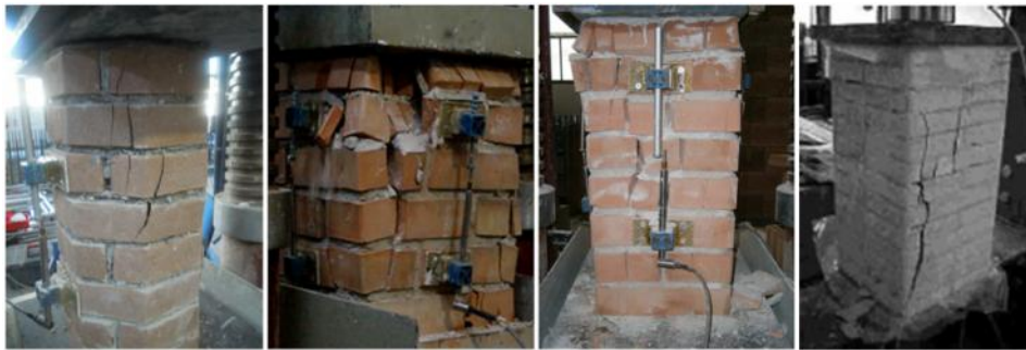
1.3 pav. Centriškai gniuždomojo mūro suirimo charakteris (Castori 2014; Aiello 2009)
