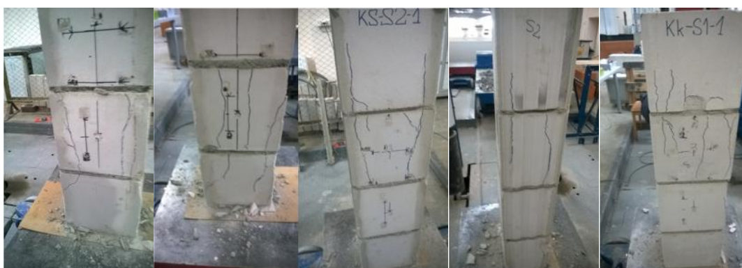
5.21 pav. Kolonų bandinių plyšių pasiskirstymas po suirimo
