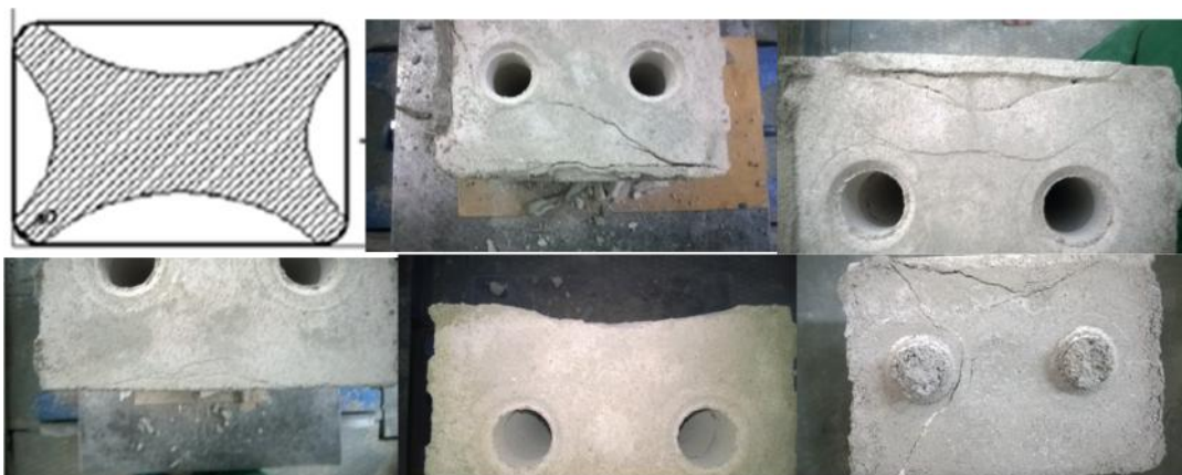
5.22 pav. Kolonų blokelių suirimo formos, teorinė ir gautos eksperimentiškai
