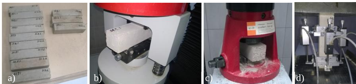
5.2 pav. Skiedinio prizmių bandymas; a - skiedinio prizmės bandymams; b - skiedinio tempiamojo stiprio lenkiant bandymas; c - skiedinio gniuždomojo stiprio nustatymo bandymas; d - skiedinio tamprumo modulio nustatymo bandymas
