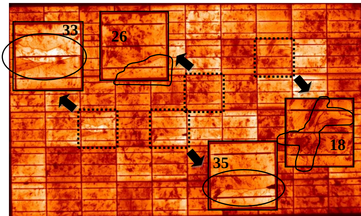
30 pav. Lūžis (35), mikroįtrūkiai (18, 26, 33) modulyje Nr. 4
