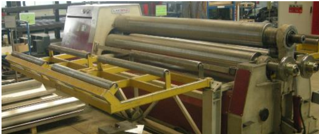
2. pav. Lakštų valcavimo staklės
