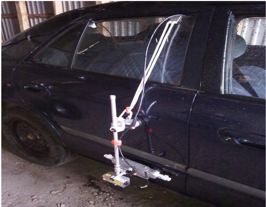
34 pav. Correvit HF-500C jutiklio bendras vaizdas ant automobilio MAZDA 626
