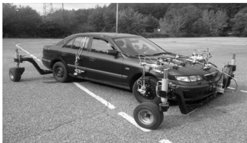
1 pav. Automobilis „Mazda 626“ ant slydimą imituojančios sistemos su sumontuota matavimo įranga
