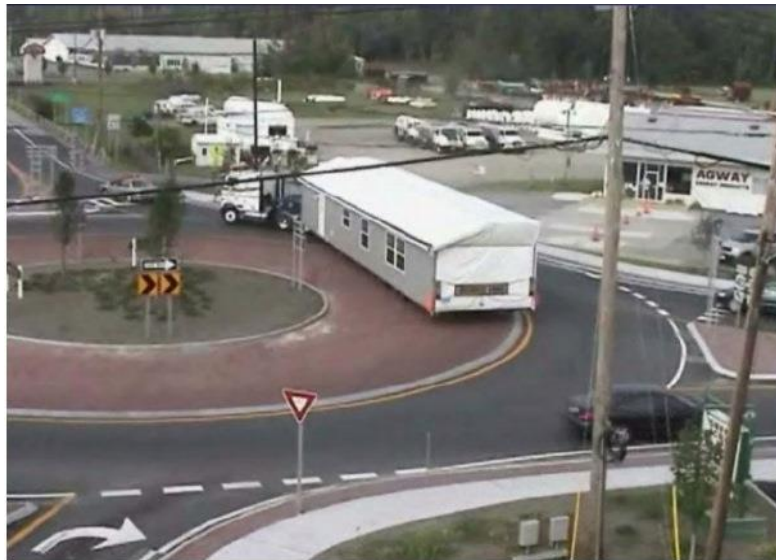
6 pav. „Sunkvežimio prijuostė“, JAV (U.S. Department of Transportation, 2000)
