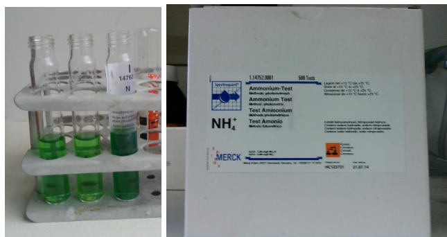
2.7 pav. Mėgintuvėliai su tiriamuoju mėginiu ir testas „Merck Spectroquant“ amonio azoto koncentracijai nustatyti (Valeikaitė 2015).
