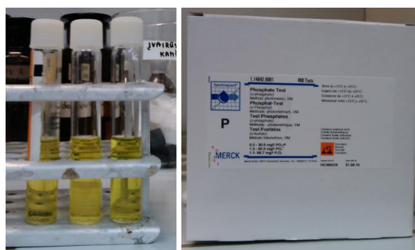
2.8 pav. Mėgintuvėliai su tiriamuoju mėginiu ir testas „Merck Spectroquant“ orto-fosfatų fosforo koncentracijai nustatyti (Valeikaitė 2015).
