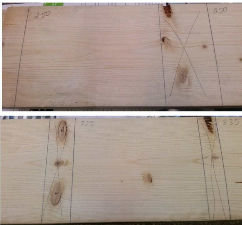
2.6 pav. Vietų su defektais pašalinamas iš medinių tašų
