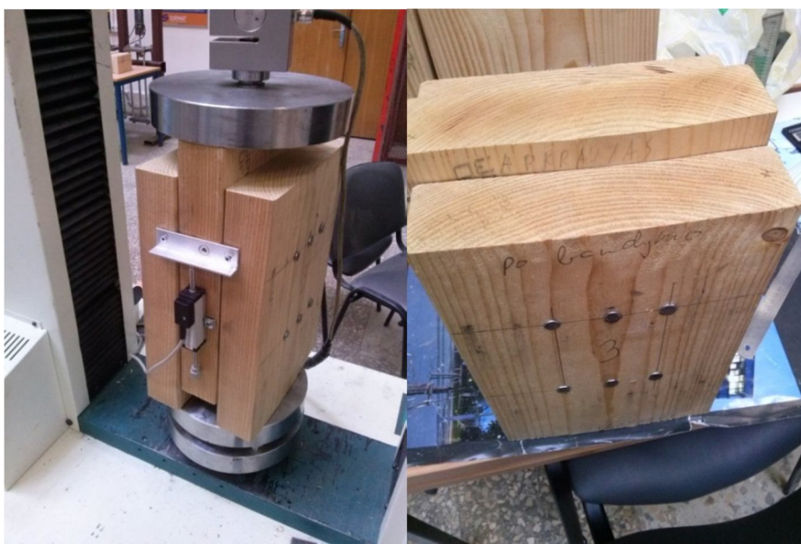
2.16 pav. Bandinys nr. 3 bandymo metu ir po bandymo
