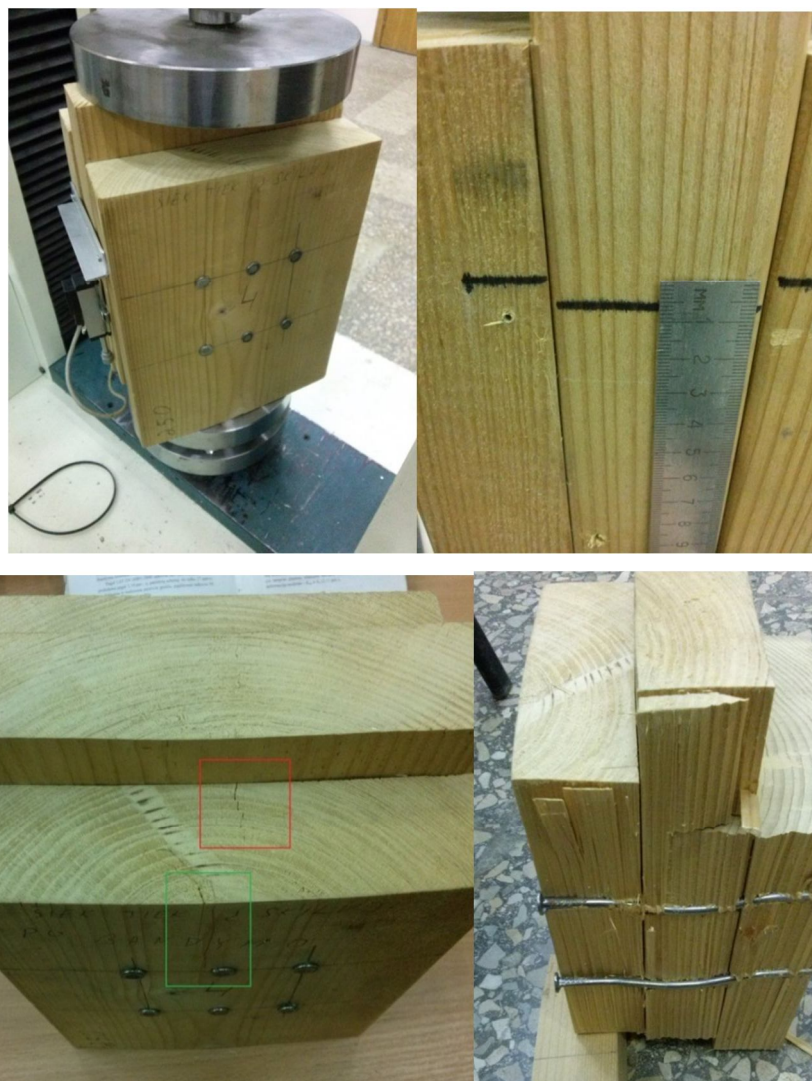
2.54 pav. Bandinys nr. 4 bandymo metu ir po bandymo
