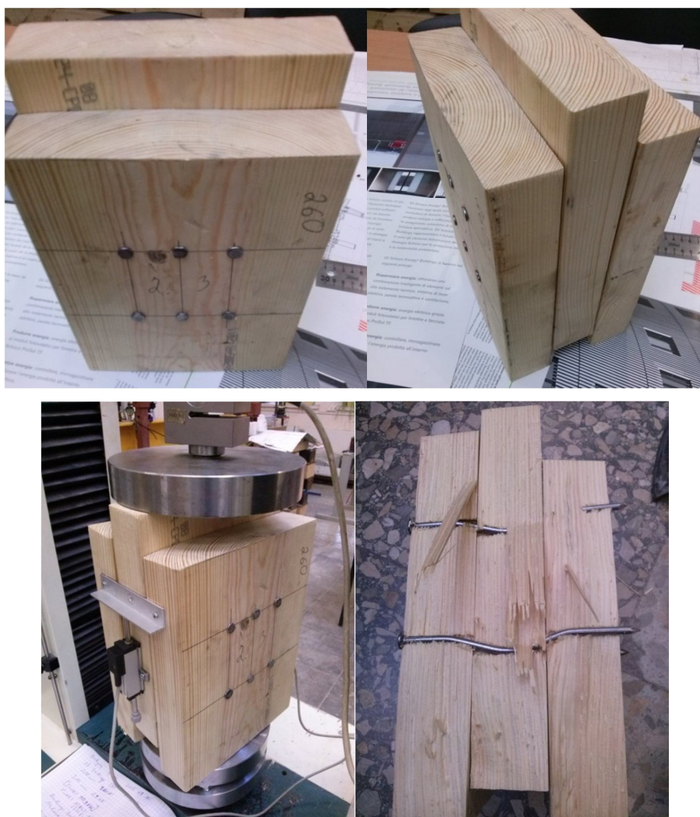
2.43 pav. Bandinys nr. 23 bandymo metu ir po bandymo
