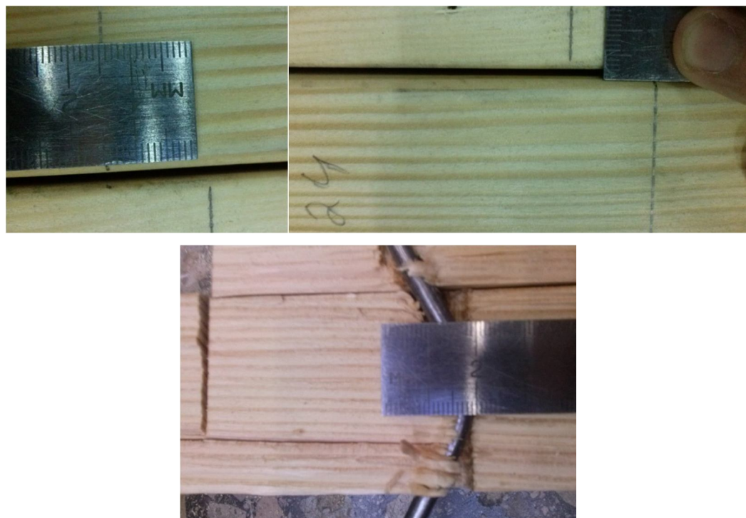
2.44b pav. Bandinys nr. 24 bandymo metu ir po bandymo
