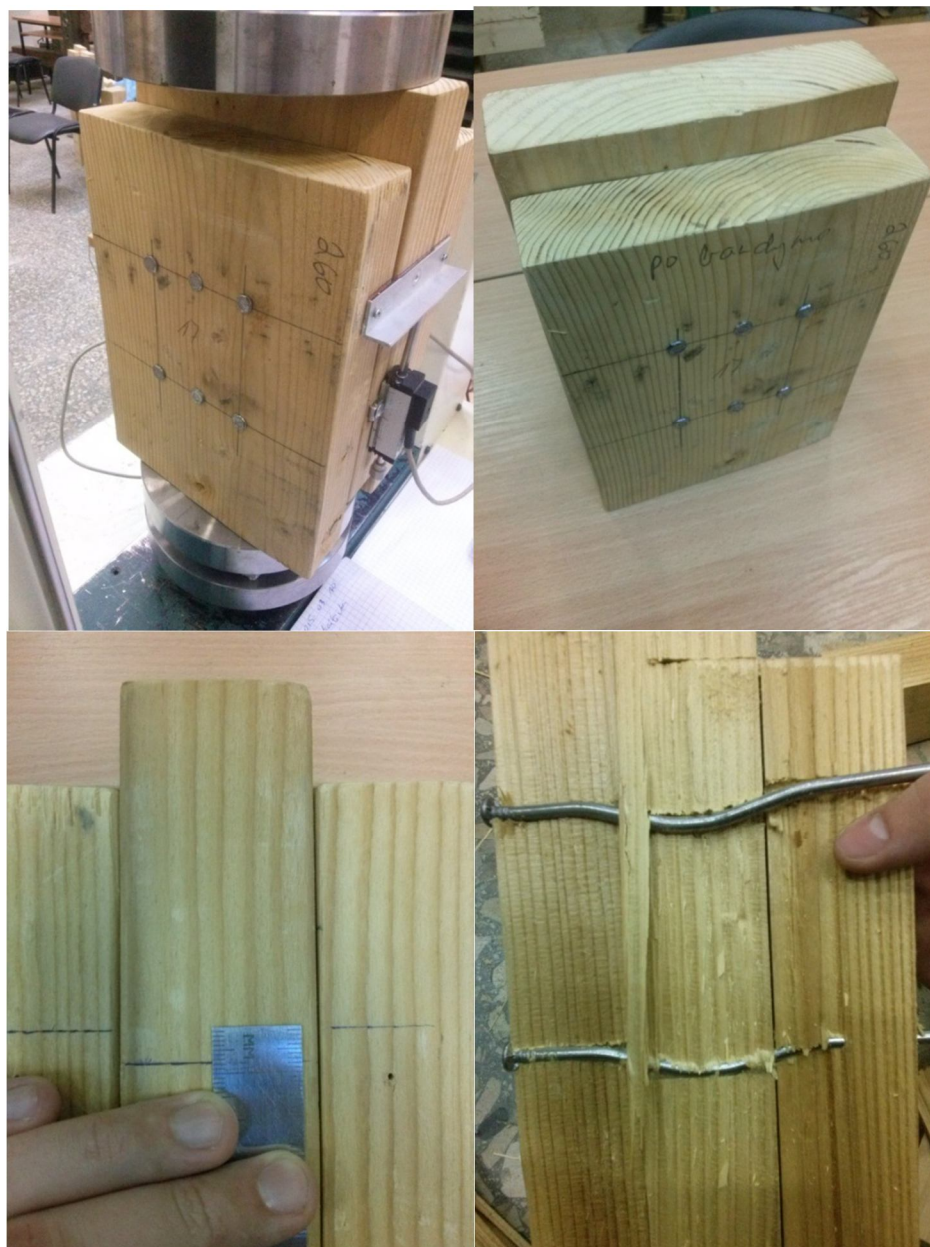
2.36 pav. Bandinys nr. 17 bandymo metu ir po bandymo
