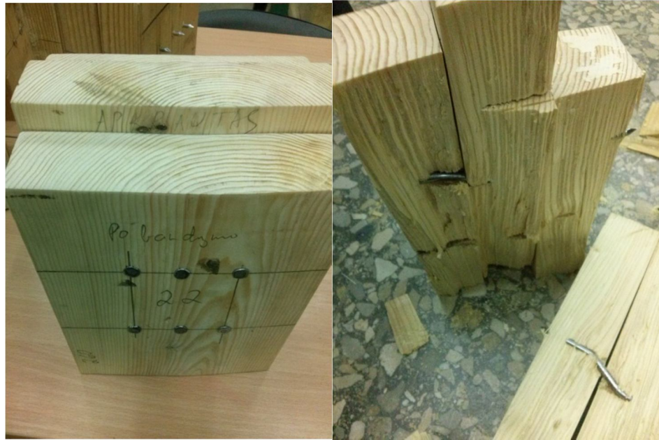
2.45b pav. Bandinys nr. 22 bandymo metu ir po bandymo
