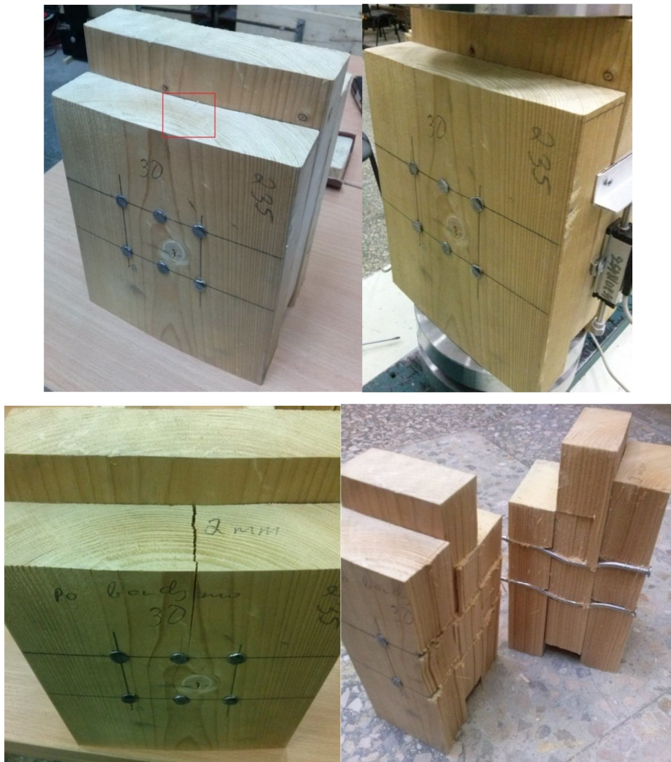
2.71 pav. Bandinys nr. 30 bandymo metu ir po bandymo
