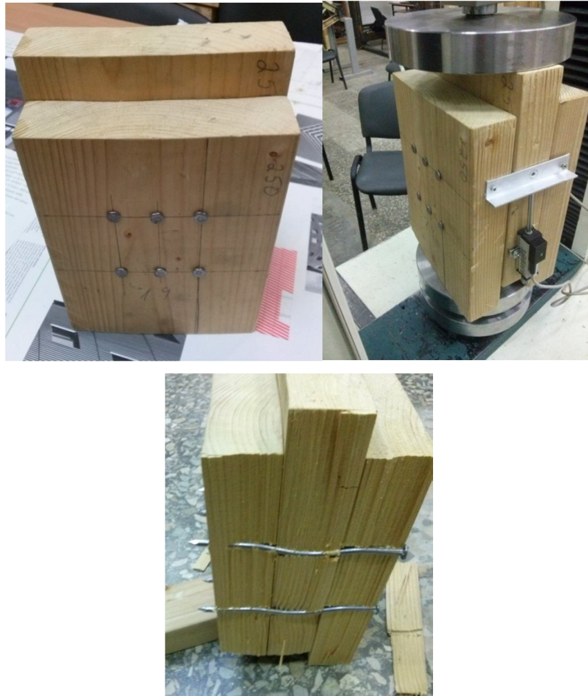
2.52 pav. Bandinys nr. 19 bandymo metu ir po bandymo
