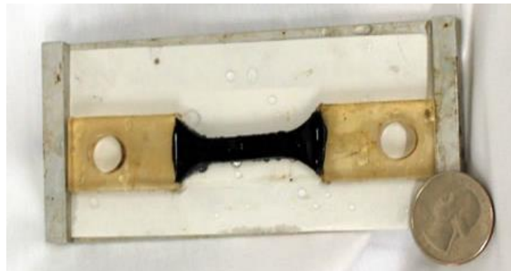
2.4 pav. Tiesioginio tempimo bandymui paruošas specialios formos bandinys (Pavement... 2011)
