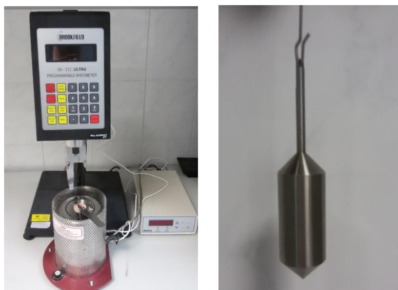
3.4 pav. Dinamīnēs klampos nstatymas: a) sukusis klampomātis Brookfield DV-III Ultra b) cilindrinis antgalis Nr. 21
