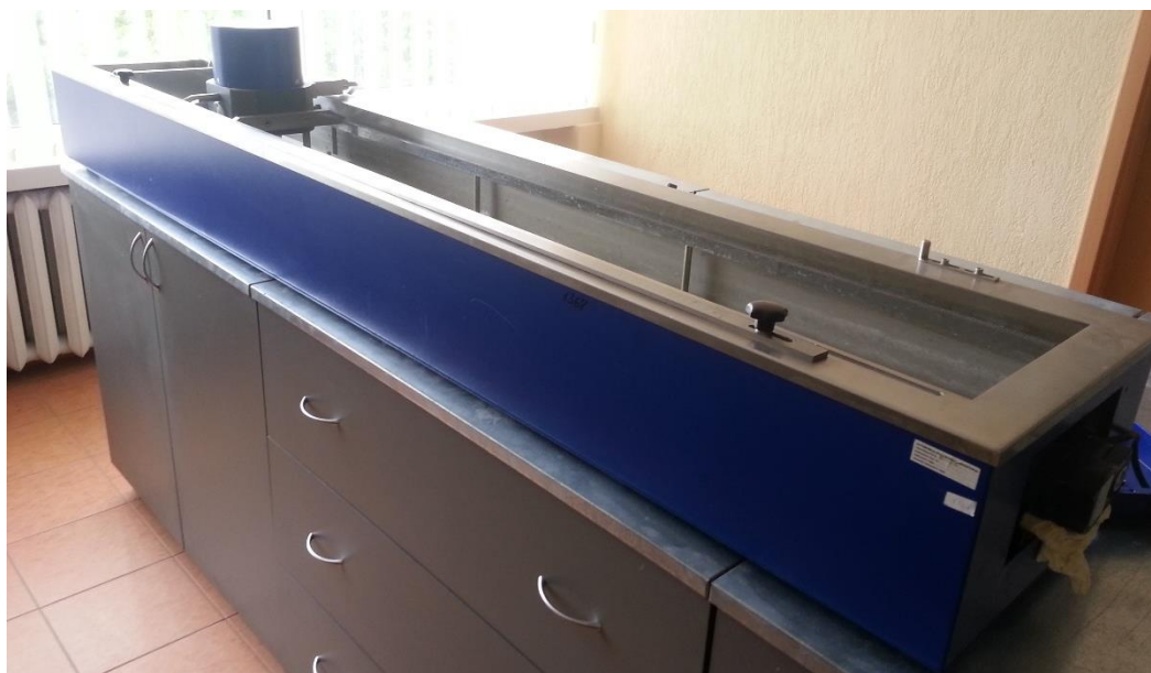
3.5 pav. Tampriosios atstatos nustatymas (Duktilometras)
