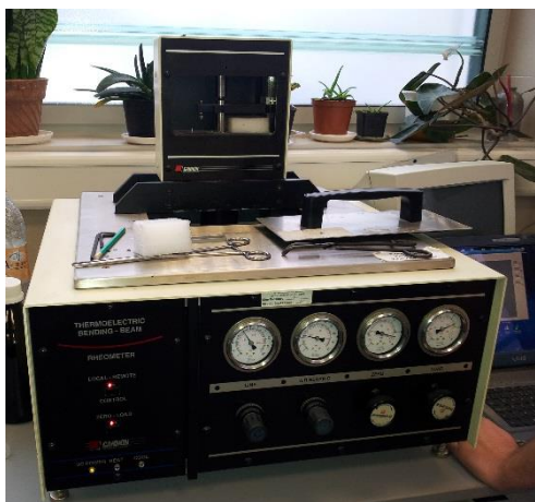
3.6 pav. Lenkimo standžio ir lenkimo standžio kitimo rodiklio nustatymas a) lenkiamo strypelio reometras CANNON; b) sijelės lenkimas
