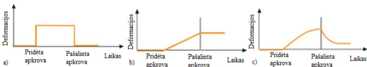
1.4 pav. Kūnų deformavimasis, kai kūnas pasižymi: a) tampriomis savybėmis; b) klampiomis savybėmis; c) klampiomis–tampriomis savybėmis
