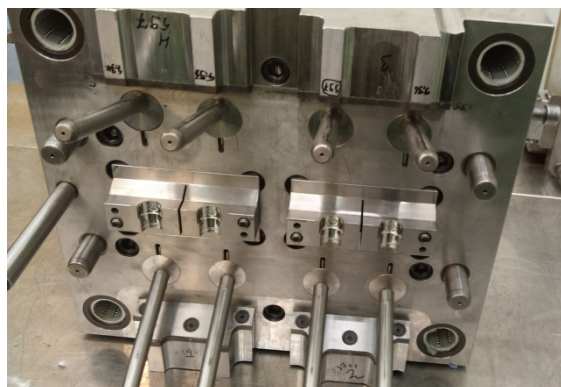
8 pav. Nejudamoji formos pusė Fig. 8. Fixed side of injection mold
