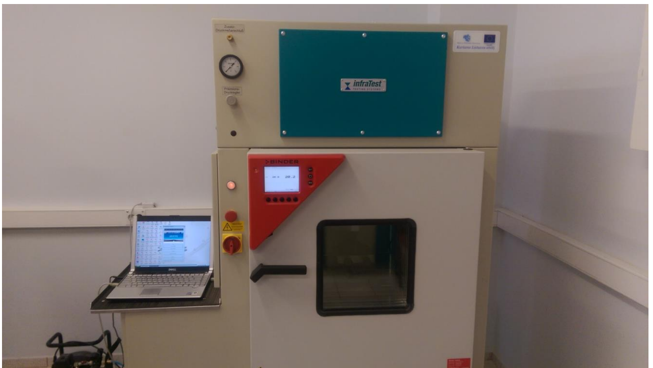
18 pav. Hidraulinis presas su klimatine kamera
