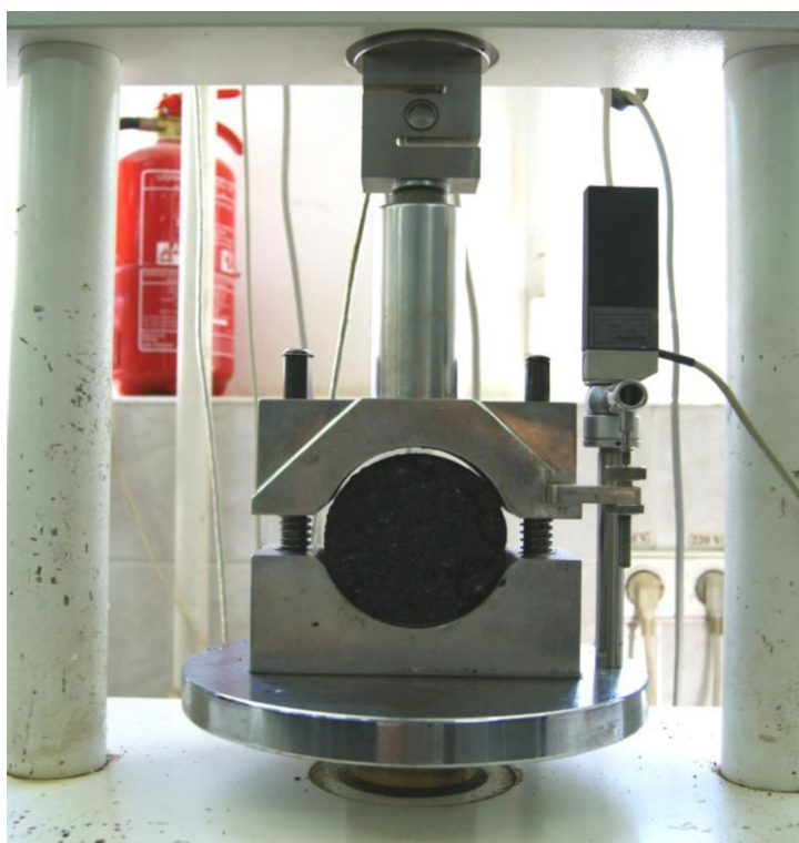
14 pav. Maršalo bandymo bandinys įdėtas į gniuždymo formą.
