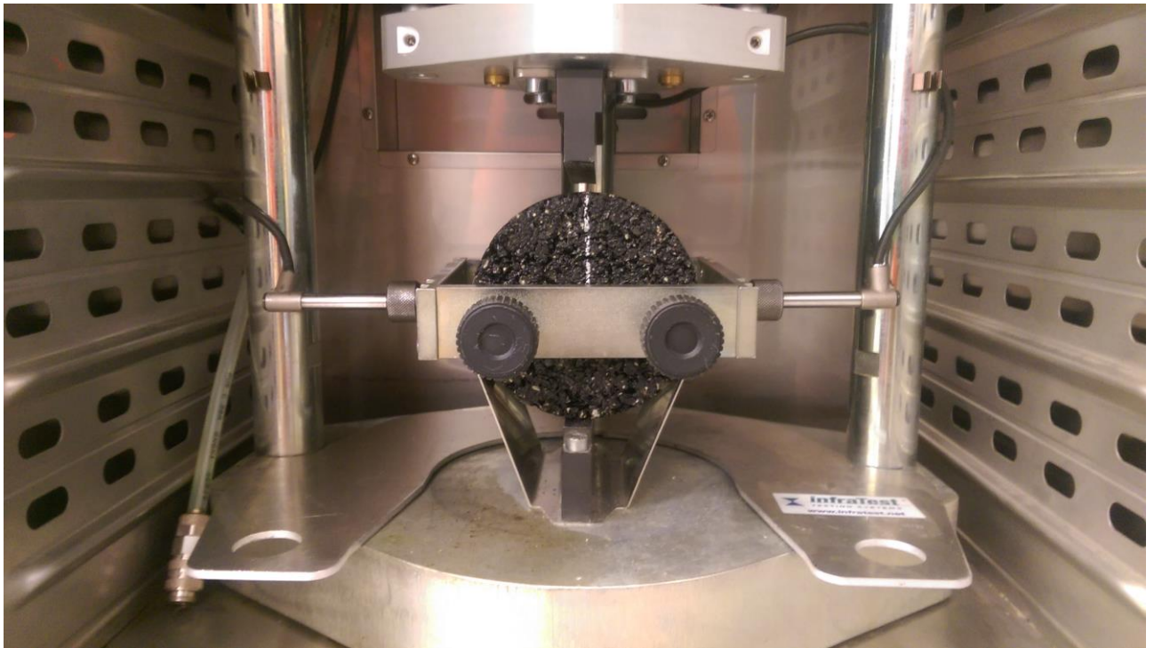
17 pav. Standumo nustatymo forma su įtvirtintu cilindrinio Maršalo bandiniu
