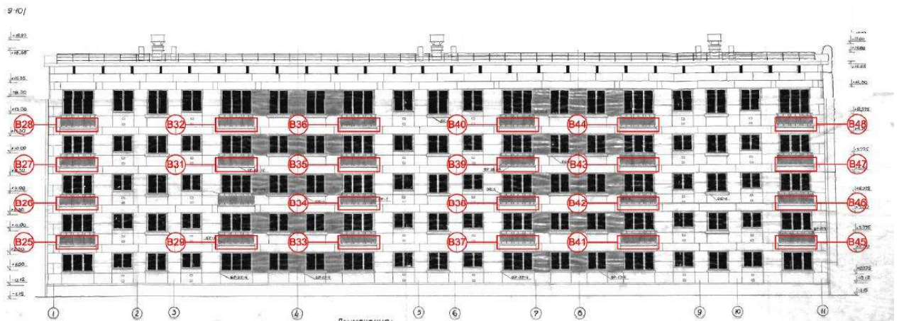
2.23 pav. Daugiabučio namo Naugarduko g. 53 gatvės fasadas su balkonų žymėjimu
