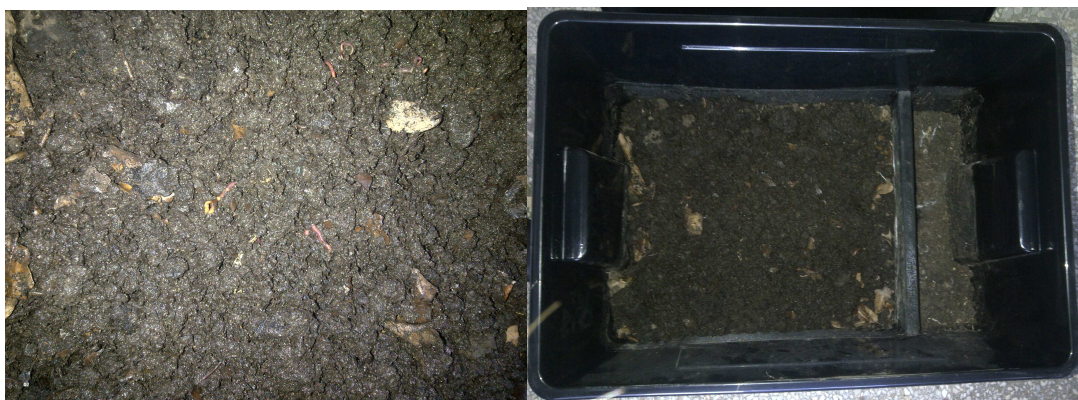
2.2 pav. Vermikompostavimui paruoštas dumblas ir jo talpinimo dėžė su dviem sekcijomis
