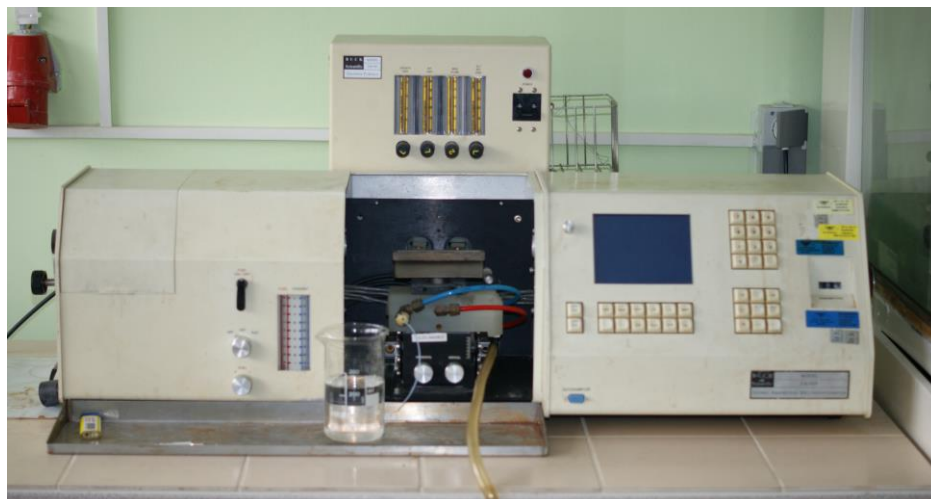
2.8 pav. Atominis absorbcinis spektrometras „Buck Scientific 210 VGP“ (Autorės nuotr.)
