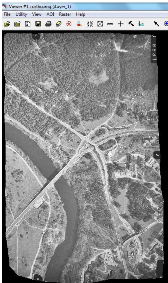
3.30 pav. Ortofotografinė nuotrauka, sugeneruota LPS programa
