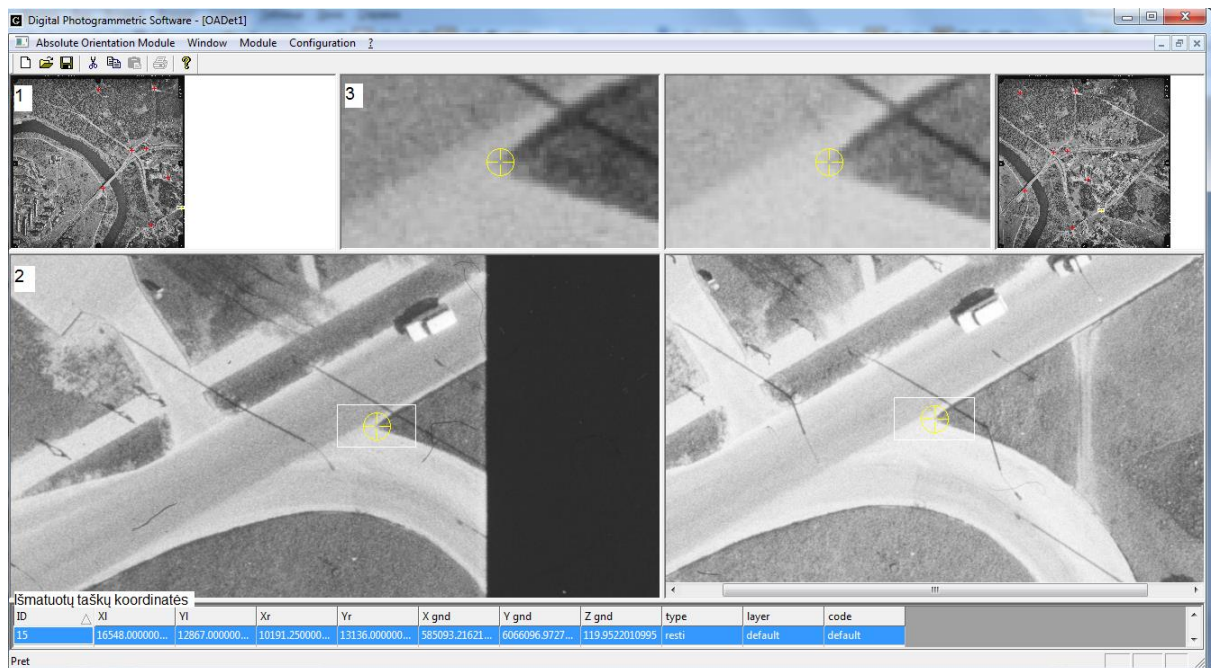
3.31 pav. Matavimo fotogrametrine sistema DDPS procesas
