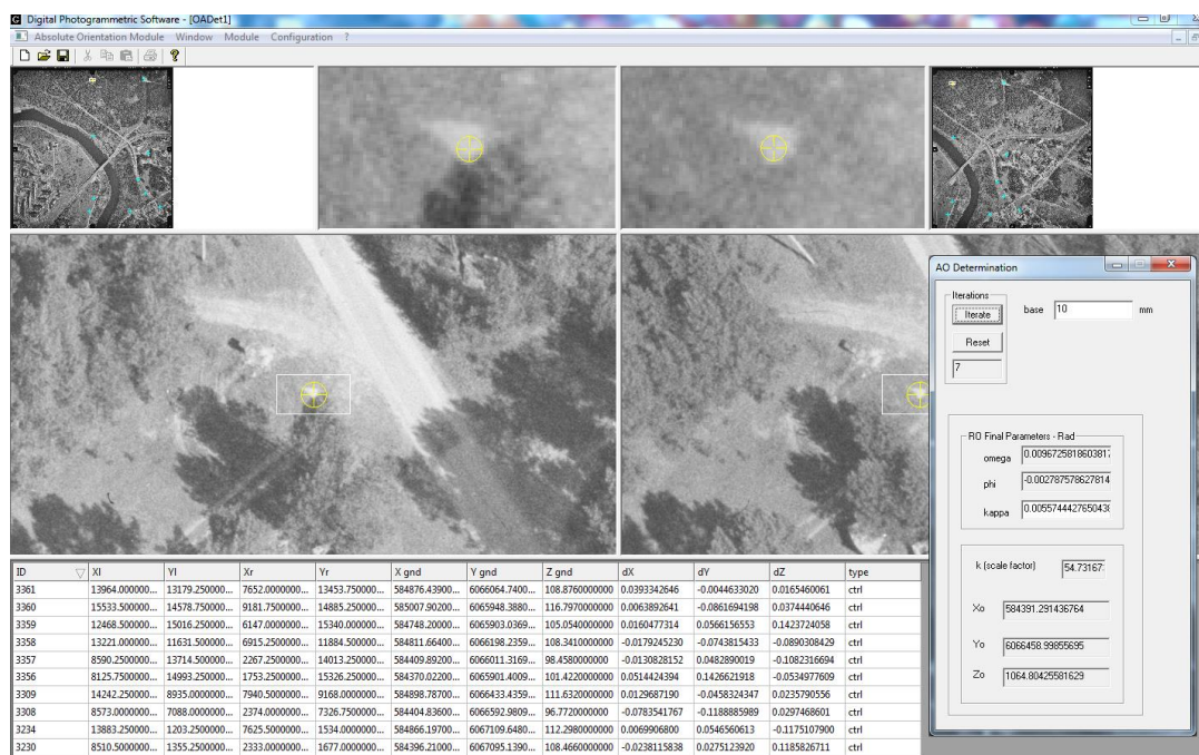
3.27 pav. Absoliučiojo orientavimo rezultatai (DDPS programinė sistema)
