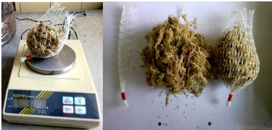
2.1 pav. Kimininių biosorbentų paruošimas (Autorės nuotrauka)
