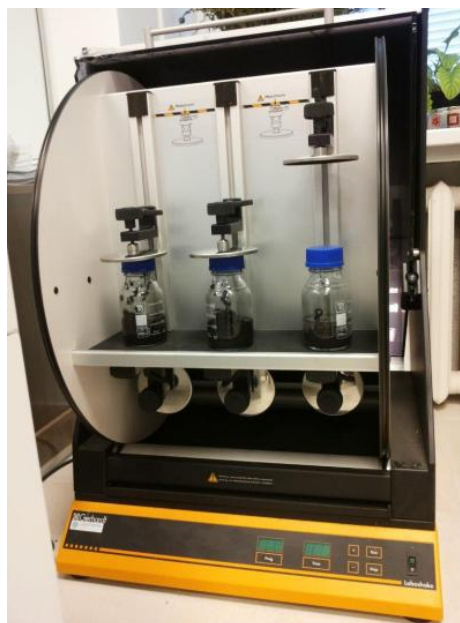
2.9 pav. Besisukančio būgno kratytuvas „Labos Shake-Gerhardt“ (Makaravičiūtė 2014)
