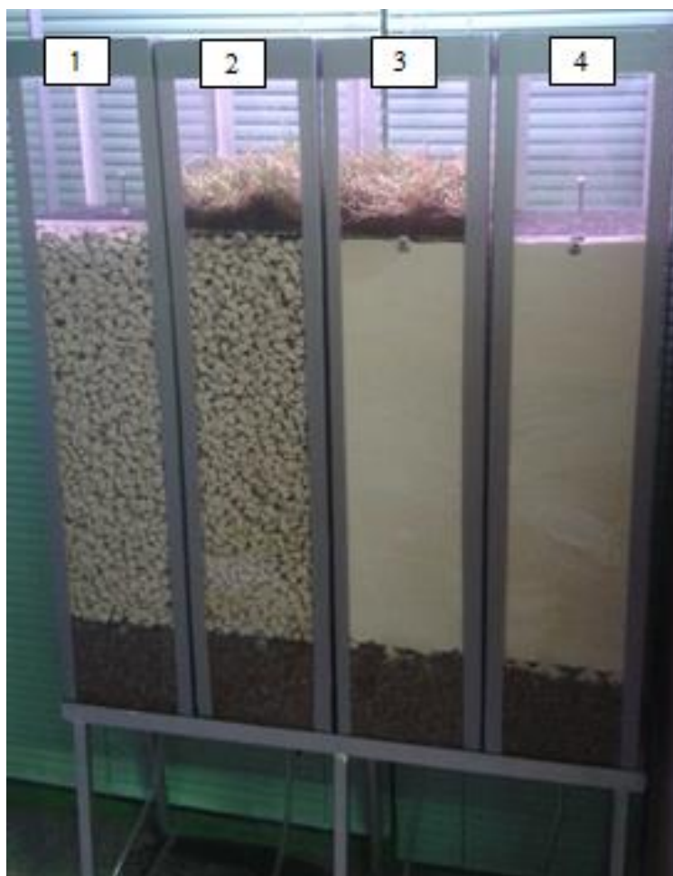
2.7 pav. Paviršinių nuotekų valymo filtrai: 1 – smulkintas autoklavinis akytasis betonas; 2 – pievinė miglė ( Poa pratensis ), autoklavinio akytojo betono skalda; 3 – pievinė miglė, kvarcinis smėlis; 4 – kvarcinis smėlis (Makaravičiūtė 2014)
