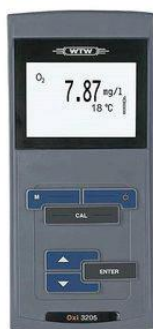
2.3 pav. Oxi 3205 ištirpusio deguonies matuoklis (oksimetras)
