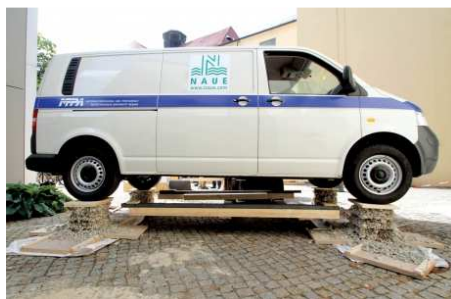
1.17 pav. Realus tamprios geotinklo darbinės stadijos pavyzdys (NAUE GmbH &amp; Co. KG): a) grunto horizontalus suvaržymas; b) rodyklėmis pažymėti geotinklų sluoksniai
