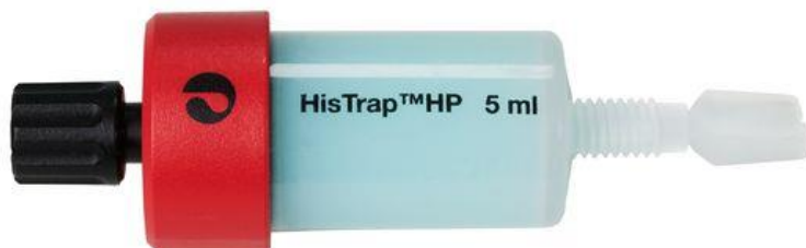
pav. 2.4 HiTrap™ IMAC kolonėlė, kurios turis 5 mL (1,6 x 2,5 cm). Kolonoje yra Sepharose™ 6 Fast Flow sorbentas, Rekomenduojamas pratekėjimo greitis 5 mL/min. (pritaikyta iš Sigmads Aldrich tinklapio).
