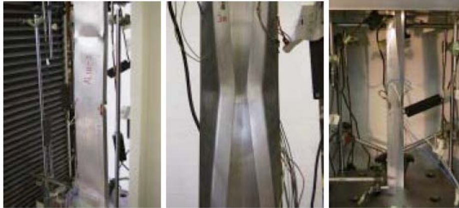
1.28 pav. Eindhoveno technologijos universitete atliekami netolygiai gniuždomų profiliuočių bandymai (Mennink, 2002)
