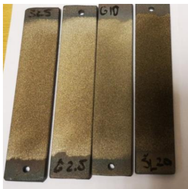
16 pav. Gautos užpurkštos dangos
