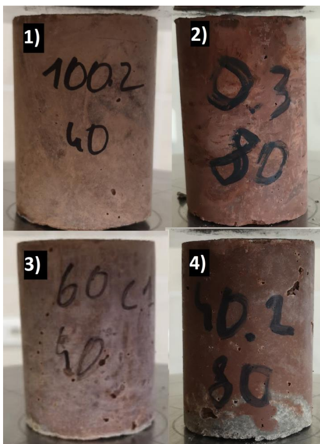
32 pav. Gruntbetonio spalva: 1 – 100 % C + 0 % LP ir 40 % MM + 60 % Sa; 2 – 100 % C + 0 % LP ir 80 % MM + 20 % Sa; 3 – 60 % C + 40 % LP ir 40 % MM + 60 % Sa; 4 – 60 % C + 40 % LP ir 80 % MM + 20 % Sa.
