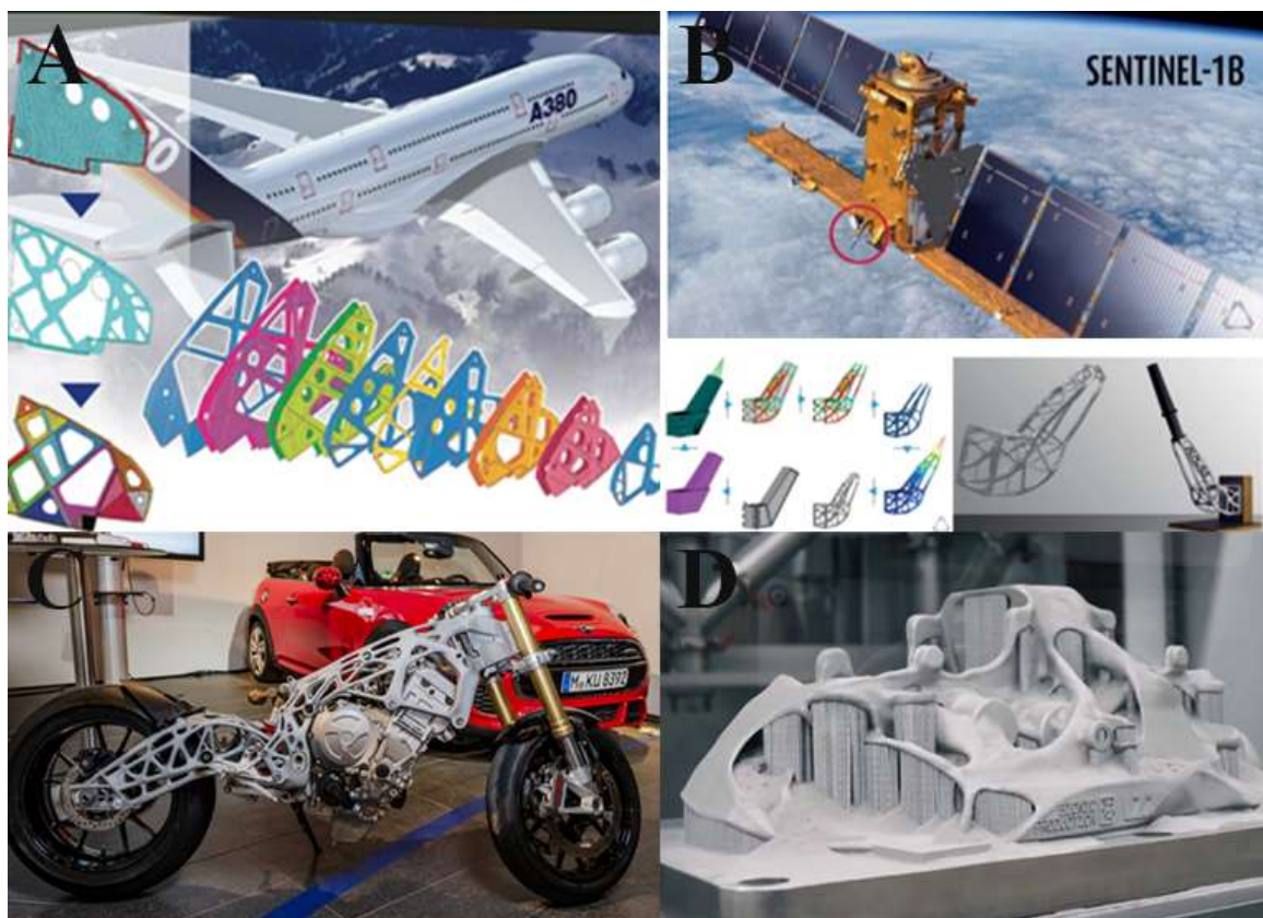
6 pav. A – lėktuvo „Airbus A380“ topologinė optimizacija; B – optimizuotas palydovas „Sentinel-1B“; C – optimizuotas BMW motociklas; D – „Bugatti“ stabdžių trinkelės laikiklio optimizacija
