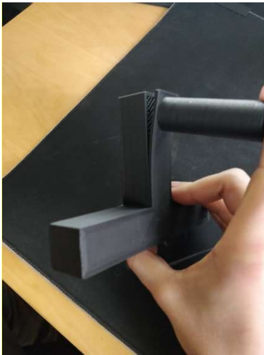
24 pav. Apkrovų neatlaikęs laikiklis
