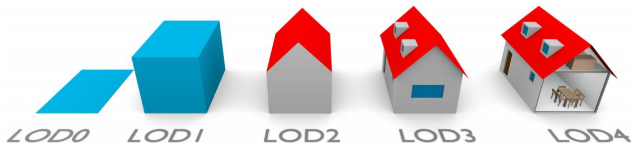
14 pav. LOD detalumo lygiai (šaltinis: F. Biljecki et al., 2016)
