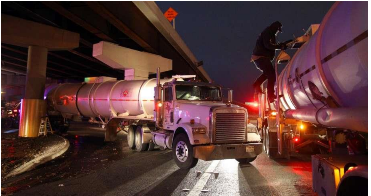
2.11 pav. Transporto avarija, įvykusi 2012 m. JAV, kurios metu cisterninei puspriekabei atsitrenkus į viaduko atramą išteko 32 m 3 žaliavinės naftos ir susidarė degus netaisyklingos formos telkinys (mySA, žr. B priedą)
