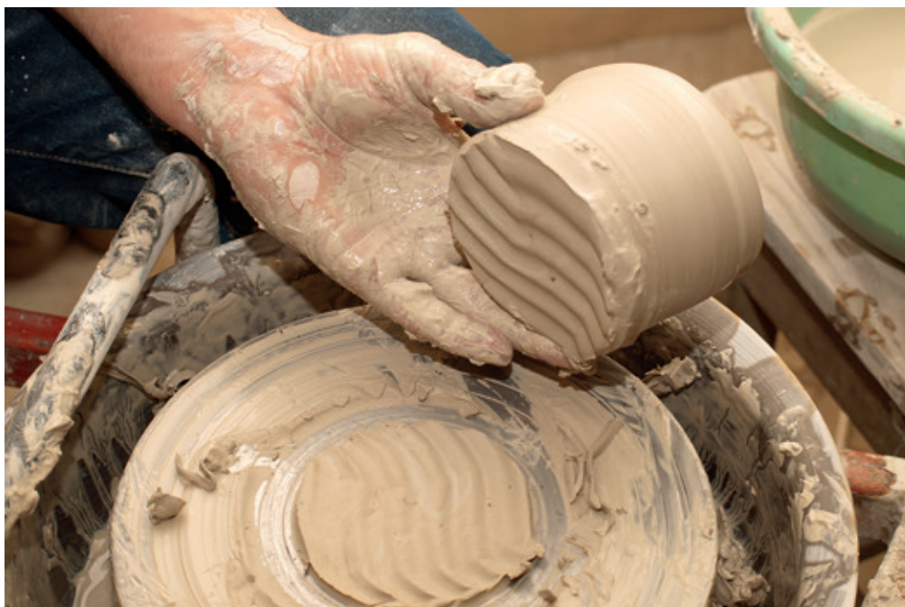
Indo nupjovimas nuo žiedimo ratelio banguota vielute, Algės Andriulytės nuotraukos Clay cutting from potters wheel with spiral, photos by Algė Andriulytė
