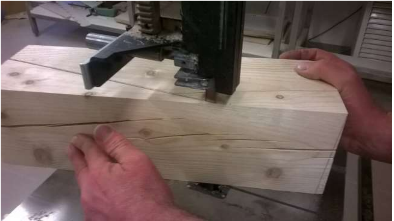
61 pav. Ruošinio formavimas juostiniu pjūklų. Objektas Nr. 2.
