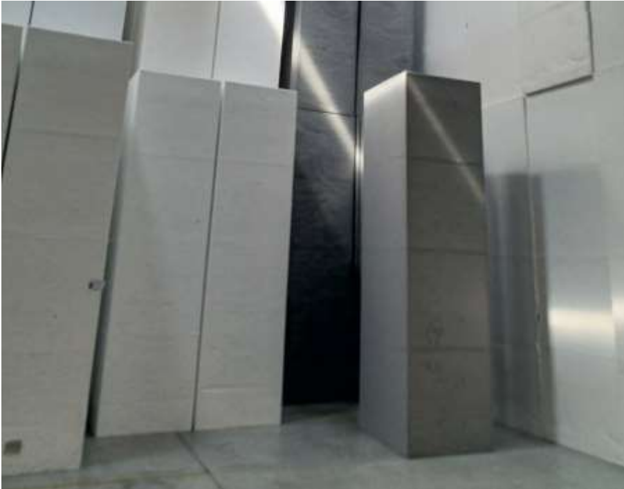
75 pav. Polistireno ruošiniai gamintojo sandėlyje. Vieno ruošinio aukštis – 4 m, svoris – 98–99 kg.
