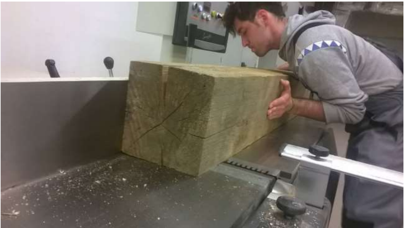
59 pav. Pirmasis technologinis etapas – ruošinio kampų formavimas.
