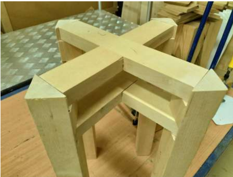
63 pav. Beržo medienos karkaso modelis. Konstrukcijos eksperimentas. Objektas Nr. 5.
