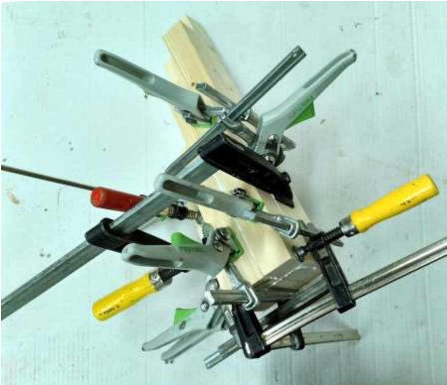
66 pav. Detalės klijavimas. Objektas Nr. 8.
