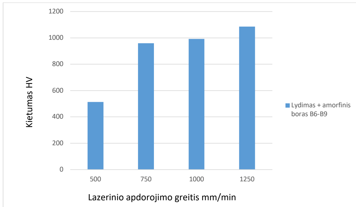
3.7 pav. B6-B9 bandinių takelių paviršių Vickerso kietumo priklausomybė nuo lazerinio apdorojimo greičio, lazerio dėmės plotis 2.0 mm
