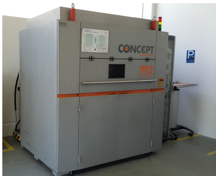
2.2 pav. „Concept laser M3“ selektinio lazerinio sukepinimo įrenginys
