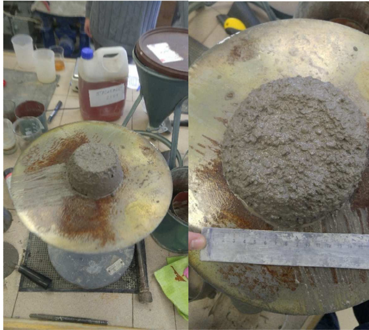
41 pav. Betono be plieninio plaušo slankumo bandymas
