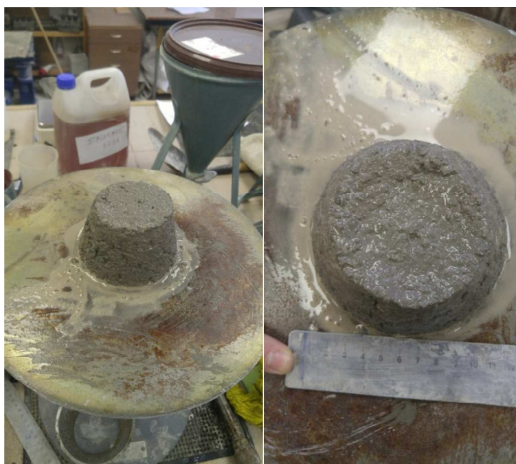
40 pav. Betono be plieninio plaušo nepavykęs slankumo bandymas
