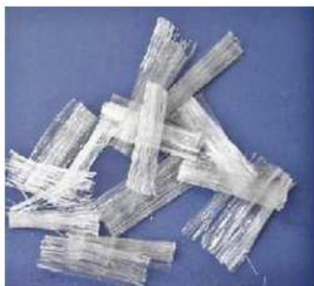
3 pav. Sintetinis polipropileno mikroplaušas (Kaklauskas et al., 2012)
