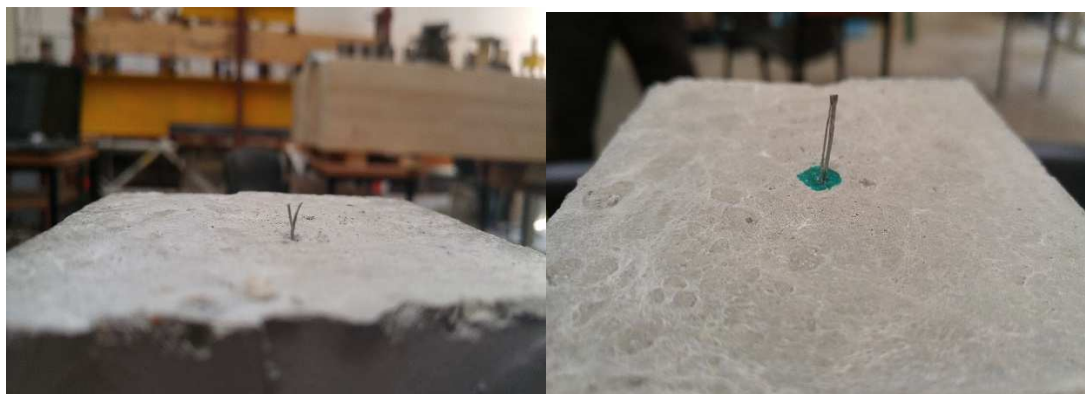
33 pav. Suirusio pilko plaušo pavyzdžiai
