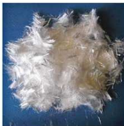
3 pav. Sintetinis polipropileno mikroplaušas (Kaklauskas et al., 2012)
