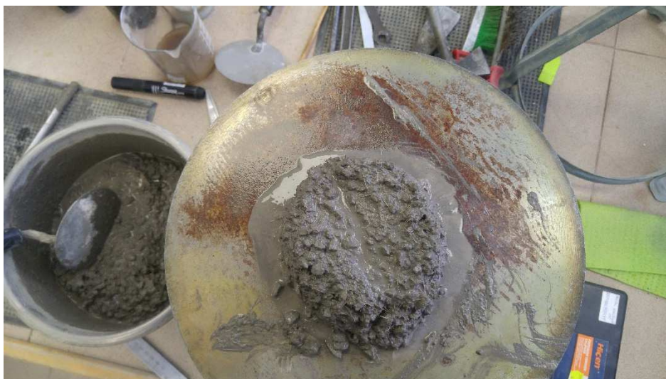
39 pav. Antrojo etapo slankumo bandymai su atsiskyrusiu vandeniu ir superplastikliu
