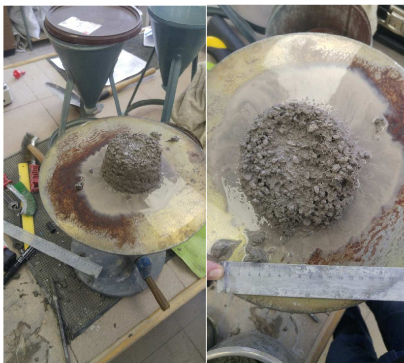
43 pav. Betono su 1 % plieninio plaušo slankumo bandymas
