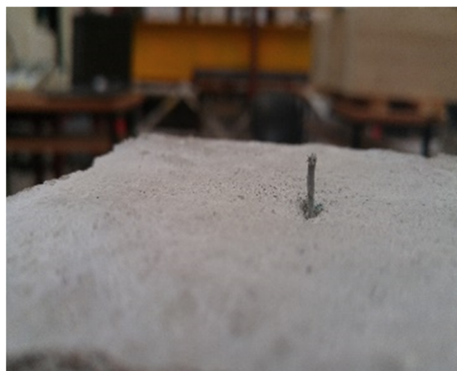
29 pav. Pažeistas ir nutrūkęs plaušas
