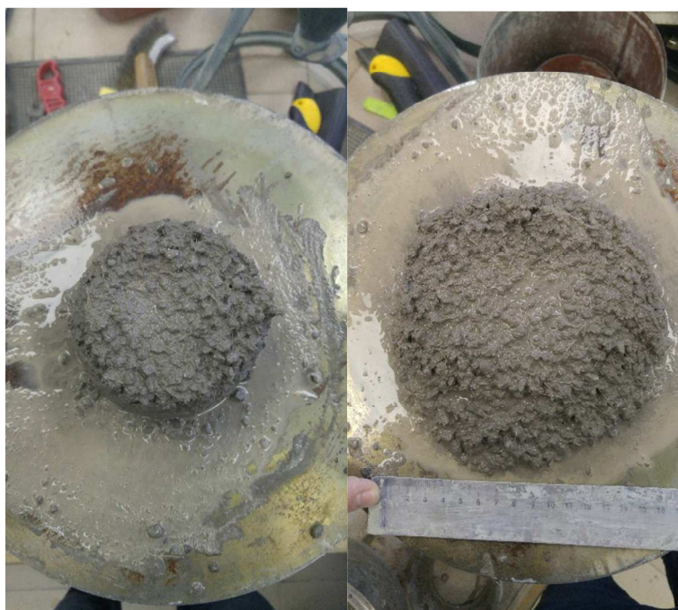
42 pav. Betono su 0,5 % plieninio plaušo slankumo bandymas
