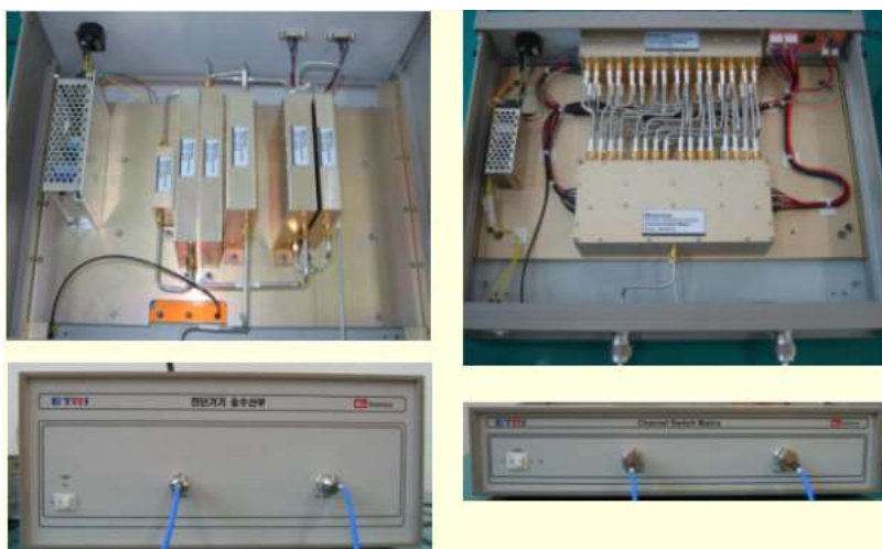
3.5 pav. Perjungiklis, sudarytas iš pramoninių komponentų [9]
