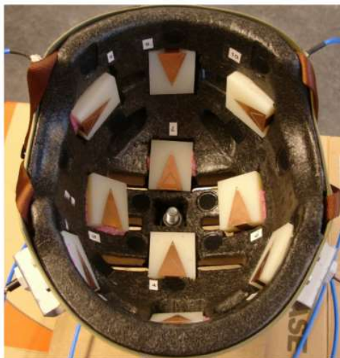
1.10 pav. Mikrobangų medicininio vaizdinimo sistemos, naudojančios klasifikavimo algoritmus, prototipas [19]
