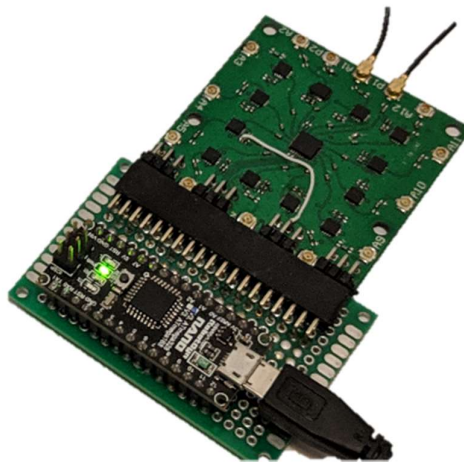
4.1 pav. Aukštadažnio perjungiklio įnešamų nuostolių matavimai (matuojama tarp RF1 ir A1)
