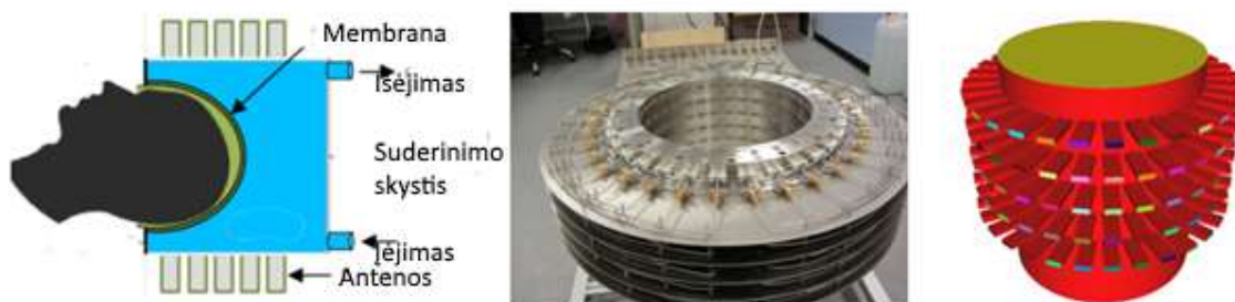
1.5 pav. Suderinimo medžiagos naudojimo principas ir visų sistemoje naudojamų antenų išdėstymas [14]
