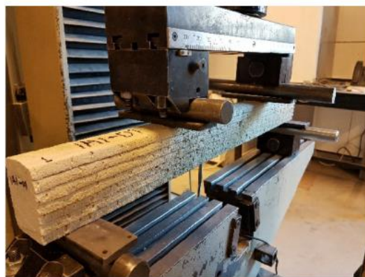
1.13 pav. 7-nių sluoksnių sija, lenkimo bandyme (kairėje), elemento iirtis dėl vielos nutrūkimo (dešinėje) (Bos et al., 2017)
